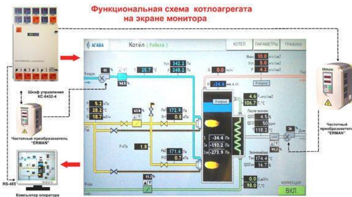
Рисунок 1 - Функциональная схема котлоагрегата на экране монитора
